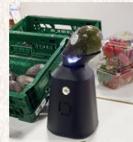
アボカドやイチゴ等で利用可能なハンディスキャナー
